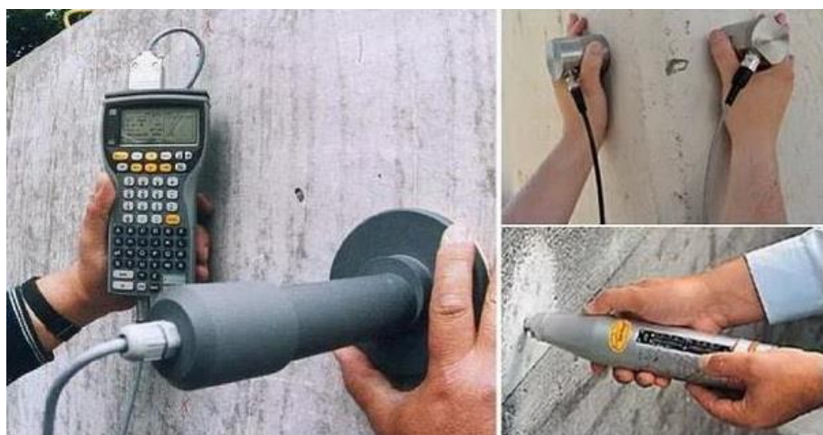
Gambar B.1.9. Pengukuran/pengujian kekuatan beton
